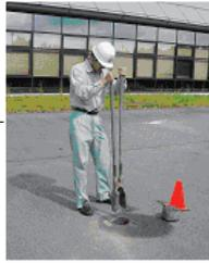
地中配管に有害物質が流れている場合は、その下部土壌が汚染のおそれが生じた場所の位置として採取
