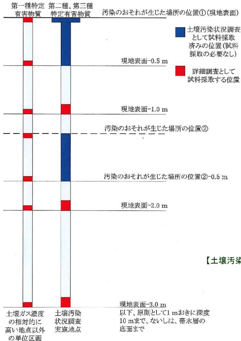
■ **揮発性有機化合物**・・・土壤ガス調査の結果では土壤汚染の有無の判断はできていない。溶出量基準超過の有無について、平面及び深度方向の分布状況の確認を同時に行う。**実施は必須。**
