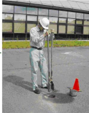
土壌汚染状況調査のうち、概況調査で土壌ガスや表層土壌を採取する位置は以下の通り。
