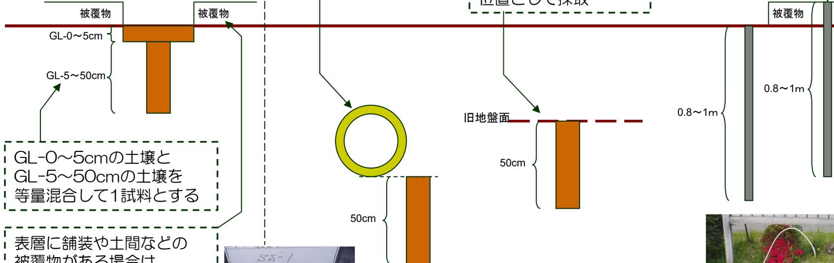
GL-0~5cmの土壌とGL-5~50cmの土壌を等量混合して1試料とする
