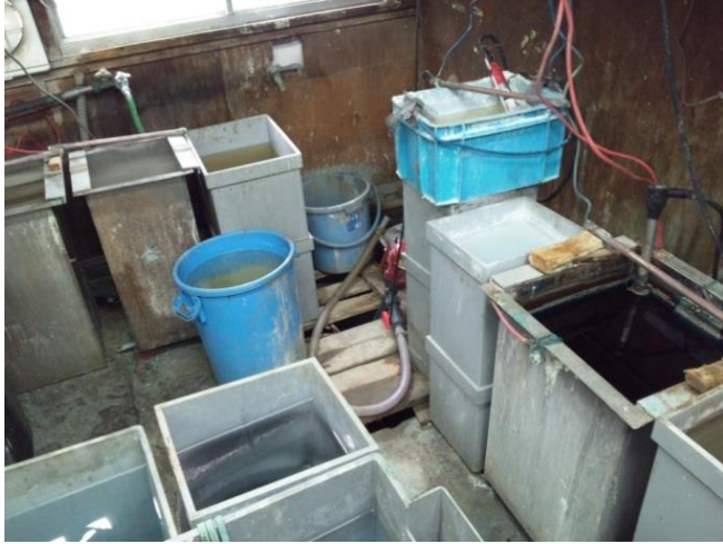
床にこぼれたメッキ液が亀裂から土壤へ浸透
