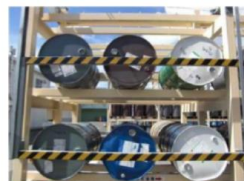
【ドラム缶の横置き落下防止例】
